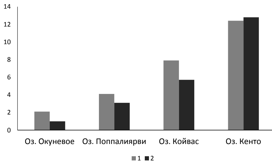
Рисунок 3.25. Разбавление воды хвостохранилища в системе р. Кенти по среднегодовым концентрациям (1994-2009 гг.) K^+ (1) и SO_4^{2-} (2)
